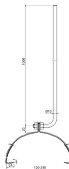
Asta di captazione per la protezione p.es. di pannelli solari, impianti fotovoltaici oppure altre installazioni su tetti spioventi. Il montaggio dell'asta di captazione si basa su una tecnica ad incastro. Gli elementi regolabili a gradini sono da adattare, prima del montaggio, a seconda del diametro delle tegole sul colmo.
