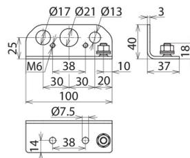
Con 3 fori di montaggio per 3 dimensioni diverse di DEHNgate, p.es. art. n. 1x 929 042 + 1x 929 057 + 1x (929 043, 929 044, 929 045 oppure 929 059).
