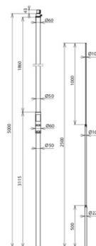
Tubo portante con terminale interno ed elemento a molla per l'equipotenzialità. Asta di captazione Ø22 / 16 / 10 mm.
