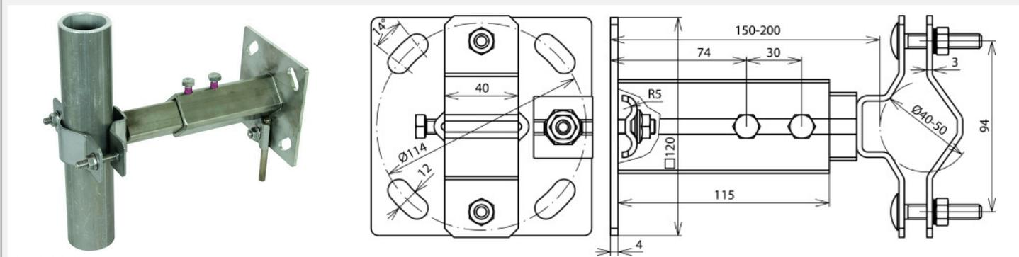
Angolare di fissaggio a parete con campo di serraggio regolabile da 150 a 200 mm per aste di captazione D40, tubi portanti DEHNcon-H o DEHNiso-Combi, dotate di cavallotto doppio di fissaggio per la connessione di 2 Td 8-10 mm.
