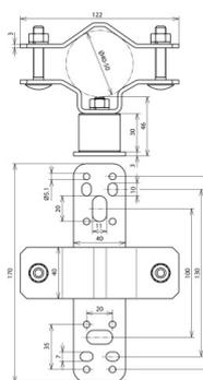
Angolare di fissaggio a parete per montaggio verticale, per aste di captazione D40, tubi portanti DEHNcon-H o DEHNiso-Combi.
