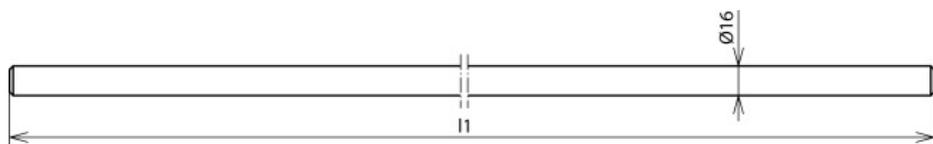
Asta di captazione bombata su entrambi i lati, per la protezione di costruzioni su tetto, camini ecc., specificatamente per zoccolo in cemento (17 Kg) con cuneo o per il fissaggio con cavallotti / distanziatori.
