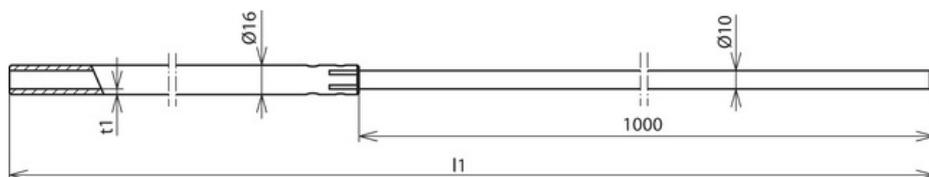
Asta di captazione tubolare con riduzione di diametro (1000 mm), esecuzione leggera bombata, per la protezione di costruzioni su tetto, camini ecc., specialmente per zoccolo in cemento (17 Kg) con cuneo o per il fissaggio con cavallotti / distanziatori.
