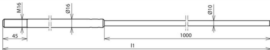
Asta di captazione bombata con riduzione di diametro (1000 mm), filetto M16, per la protezione di costruzioni su tetto, camini ecc., specialmente per zoccolo in cemento (17 Kg) con adattatore per filetto e fissaggio supplementare con distanziatore.
