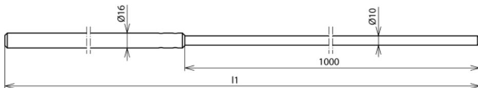
Asta di captazione bombata con riduzione di diametro (1000 mm), per la protezione di costruzioni su tetto, camini ecc., specialmente per zoccolo in cemento (17 Kg) con cuneo o per il fissaggio con cavallotti / distanziatori.
