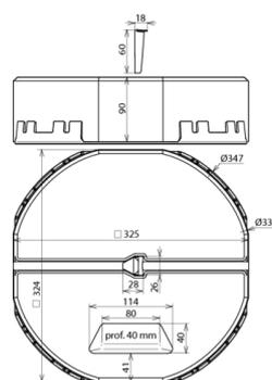
Zoccolo in cemento per aste di captazione, per la protezione di piccole costruzioni su tetti piani e per il fissaggio di distanziatori ad es. per anelli perimetrali separati, oppure per aste di captazione indipendenti con treppiede.
