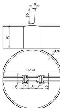
Zoccolo in cemento per punte di captazione Ø10 mm (lunghezza 1000 mm), per la protezione di piccole costruzioni su tetti piani e per il fissaggio di distanziatori ad es. per anelli perimetrali separati con distanziatori DEHNiso Ø16 mm, lunghezza fino a 675 mm (distanza 0,8 m).
