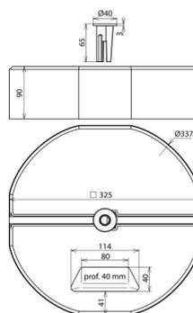
Zoccolo in cemento con adattatore filettato per aste di captazione Ø16 mm con filetto M16, per la protezione di piccole costruzioni su tetti piani.
