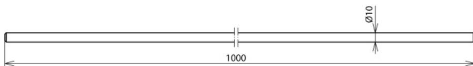
Asta di captazione bombata su entrambi i lati, per la protezione di costruzioni su tetto, camini ecc., anche per la realizzazione con zoccolo in cemento (8,5 Kg) con cuneo o per il fissaggio con cavallotti / distanziatori.
