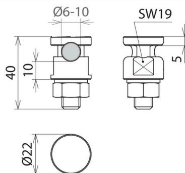
Connettore KS universale per la connessione resistente alla corrente di fulmine sia di conduttori tondi sia di conduttori rigidi e semirigidi, ad es. su profili piatti, pluviali e barre per l'equipotenzialità.
