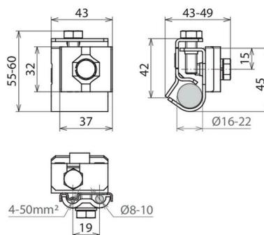
Morsetto per grondaia per il collegamento / connessione resistente alla corrente di fulmine della messa a terra di pali d'antenna (ad es. 16 mm<sup>2</sup>) sul punto d'incrocio con una gronda del tetto.
