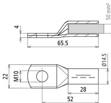
Capocorda a crimpare DIN 46235 con strato barriera in nichel per evitare la formazione di whisker.
