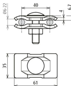
Per il collegamento di due conduttori in modo parallelo, con una vite.
