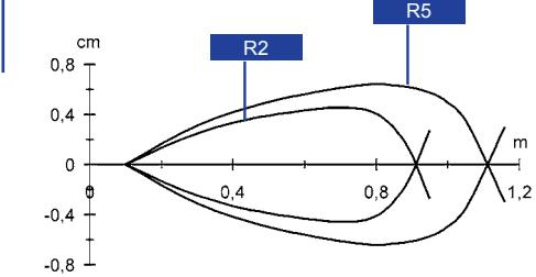
I diagrammi di rilevazione indicano la distanza operativa tipica con excess gain 1
