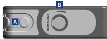
**A** LED stato uscita e Stability (ricevitore);
