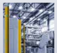
Barriere di Sicurezza
