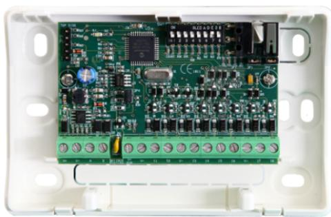
Espansione per centrali serie Vedo, 8 ingressi, liberamente configurabili come NC, NO, singolo, doppio, triplo bilanciamento e double, o 8 uscite open collector (100 mA max). Alloggiato in contenitore plastico antifiamma colore bianco RAL9003 completo di tamper anti-apertura e anti-strappo escludibili. E' possibile alloggiarlo anche all'interno dei contenitori art. BOXSTANDARD, BOXPLASTIC, BOXMETAL e BOXFLUSH. Dimensioni (L x H x P)126 x 80 x 32 mm. EN50131 grado 2
