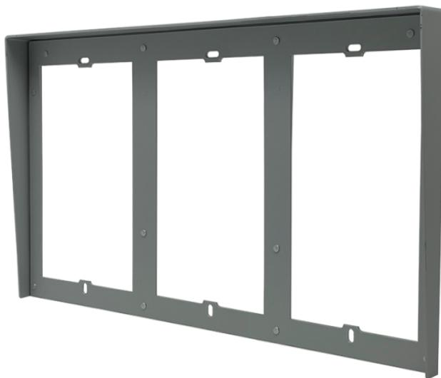
Visiera parapioggia per telai da incasso 9 moduli (3 supporti da 3 moduli affiancati) per pulsantiera Ultra. Realizzata in alluminio anodizzato di colore grigio. Dimensioni (L x H x P): 386 x 322 x 32mm.
