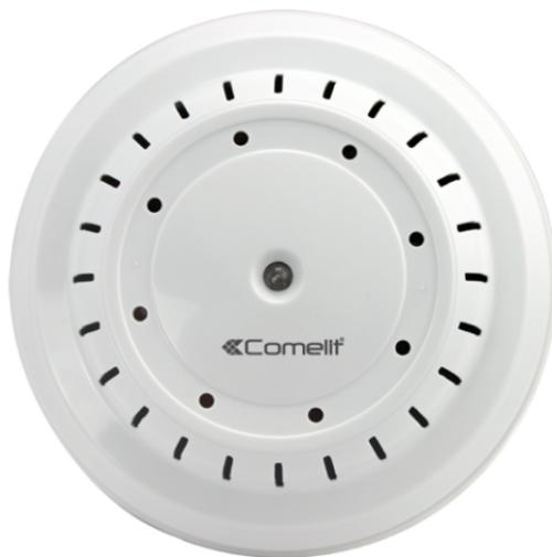
Sensore di gas naturale (metano), norma di riferimento rivelazione di gas combustibili GB15322-2003, contenitore in ABS bianco, concentrazione del Gas 6% LEL, alimentazione 12 VDC, assorbimento 100 mA in stand by e 140 mA in allarme, relè di uscita C/NC/NO, buzzer. 85 dB ad 1 metro, temperatura di funzionamento da -10 a + 50°C, dimensioni diametro 115 X 45 mm.
