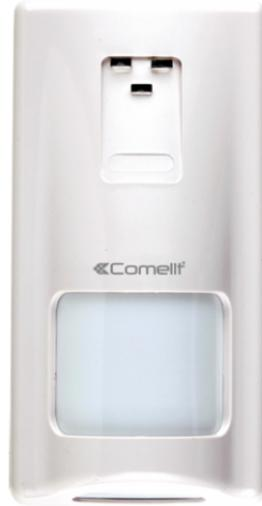
Sensore doppia tecnologia pet immunity (15 kg), montaggio a parete (staffa inclusa) . Modulo microonde (4 sorgenti) a chiusura ermetica, doppio infrarosso + analisi digitale intelligente. Portata 12m. Tensione di alimentazione 9÷16Vdc. Corrente assorbita durante il normale funzionamento 25mA. Zona di copertura 110°. Installazione a parete. Dimensioni: 64x120x48mm.
