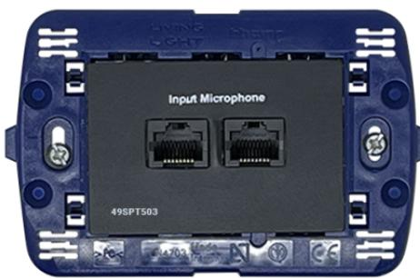
Sdoppiatore di linea con 2 porte RJ45 montato su supporto a 3 unità per scatola ad incasso, serie civile PLANA. Da utilizzare per la connessione (in/out) di basi microfoniche d'emergenza e servizio LogiVox. Può esser completato con le placche Comelit a 3 posti della serie ONE (codici ONE/Px/VP3).
