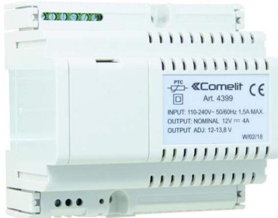
Alimentazione secondaria 12 VDC 4A primaria 240 VAC. La tensione di uscita secondaria è regolabile tra 12 VDC e 13,8 VDC. Contenitore a 6 moduli DIN. Dimensioni: 105x95x65 mm.
