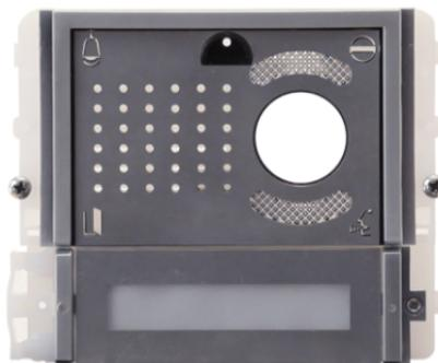
Modulo predisposto per portiere audio/video, con finitura acciaio inox. Cartellini portanome con illuminazione a led selezionabile tra blu, bianca e spenta. Da completare con il relativo portiere videocitofonico che dipende dal sistema di cablaggio utilizzato. Dimensioni 112x89,5x32 mm.
