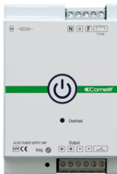
Alimentatore switching da fondo quadro. Tensione di ingresso 115/230VAC, uscita stabilizzata 24VDC. Corrente di uscita 7A. E' possibile l'installazione in parallelo di più alimentatori della stessa tipologia. E' dotato di un contatto pulito che permette di attivare un secondo alimentatore in caso di guasto oppure di attivare una segnalazione acustica o visiva. Contenitore in alluminio ed acciaio verniciato. Grado di protezione: IP20. Dimensioni (L x H x P): 75 x 112 x 132 mm.
