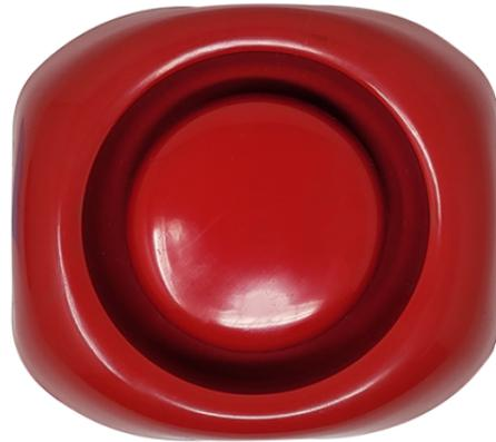
Avvisatore acustico ad alta resa con consumi ridotti, progettato per sistemi antincendio e montaggio a parete. Dispone di 32 toni principali e 32 alternativi, possibilità di 4 livelli differenti di volume. Potenza sonora ad alto volume 105dB (A) @ 1mt. Assorbimento 4mA / 2,3mA / 1,3mA / 1mA (volume alto / medio alto / medio basso / basso). Alimentazione 9-60 Vcc. Grado di protezione IP21. Dimensioni (H x W x L) 45x109x120mm. Certificazione secondo EN 54-3.
