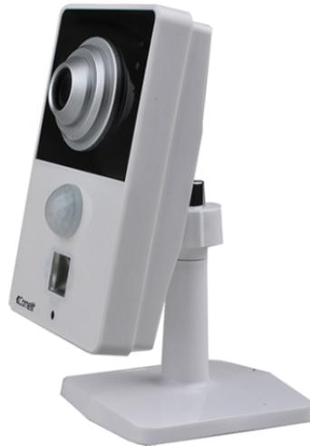
Telecamera IP all-in-one a colori Day & Night, collegamento wireless o cablato, ottica fissa da 3.6 mm, risoluzione FULL-HD (1080p)@30 ips, contenitore tipo CUBE adatto all'utilizzo in ambienti interni, 1 illuminatore a infrarosso con portata di 10 metri.
