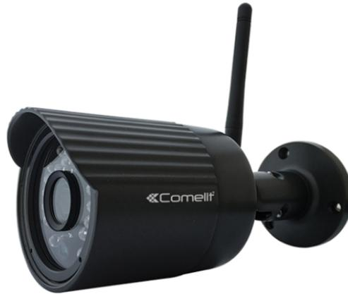
Telecamera IP all-in-one a colori Day & Night, collegamento wireless o cablato, ottica fissa da 3.6 mm, risoluzione HD (960p)@30 ips, contenitore waterproof IP66, 16 illuminatori ad infrarosso SMD con portata di 20 metri (SMART IR).
