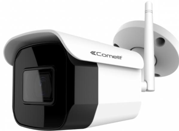
Telecamera IP Wi-Fi bullet a colori Day & Night, ottica fissa da 3.6 mm, risoluzione FULL-HD (1080p)@30 ips, contenitore waterproof IP66, 14 illuminatori ad infrarosso con portata di 30 metri (Smart IR) per kit art. WIKIT004S02NA. Alimentatore in dotazione.
