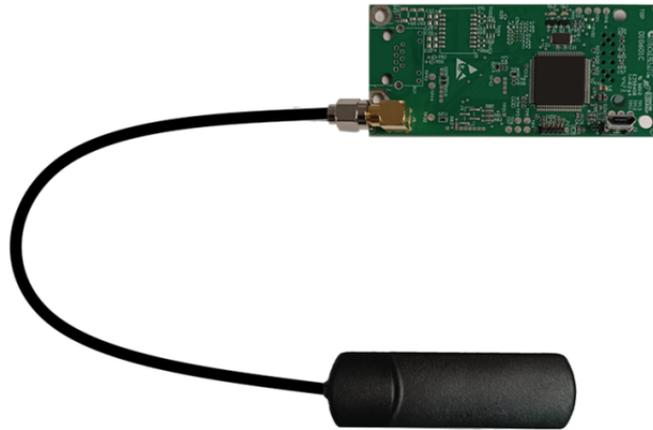
Scheda di espansione ad innesto per la comunicazione wireless delle centrali della serie Vedo. Permette l'interazione da remoto per la gestione e l'aggiornamento firmware della centrale, delle tastiere, dei lettori di prossimità e dei moduli di ingresso/uscita. Server web integrato.
