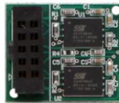
Scheda di espansione messaggi vocali plug-in per centrali serie Vedo. Aggiunge le funzioni di guida vocale per la gestione da remoto della centrale e di messaggistica audio (messaggi di allarme e tecnici). EN50131 grado 2
