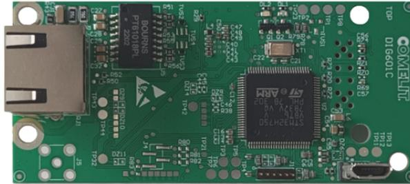
Scheda di espansione plug-in per la comunicazione su rete ethernet TCP/IP per centrali serie Vedo. Permette l'interazione da remoto per la gestione della centrale e l'aggiornamento del firmware della centrale, delle tastiere, dei lettori di prossimità e dei moduli ingressi/uscite. Web server integrato. EN50131 grado 2.
