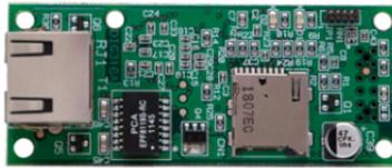
Scheda di espansione plug-in per la comunicazione su rete ethernet TCP/IP per centrali serie Vedo. Permette l'interazione da remoto per la gestione della centrale e l'aggiornamento del firmware della centrale, delle tastiere, dei lettori di prossimità e dei moduli ingressi/uscite. Web server integrato. EN50131 grado 2.
