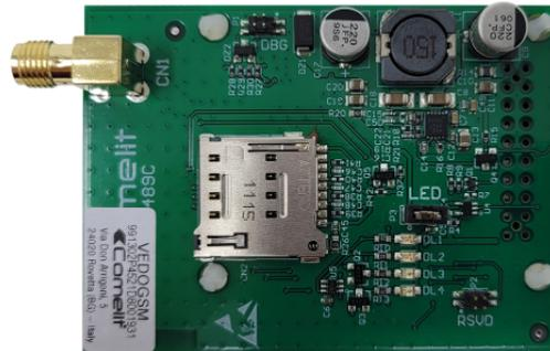
Scheda di espansione comunicatore GSM plug-in per centrali serie Vedo. Permette l'invio delle chiamate telefoniche, degli SMS, degli MMS e delle e-mail sulla rete dati. Abbinata alla scheda messaggi vocali art. VEDOVOICE, consente la gestione da remoto della centrale tramite SMS e comunicatore vocale. Articolo certificato in grado di sicurezza 2 secondo norma EN50131.
