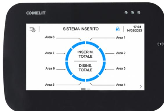
Tastiera touch screen Safe Touch per la gestione e la programmazione delle centrali di allarme della serie VEDO tramite software semplice ed intuitivo. Il dispositivo è costituito da uno schermo LCD da 5" e lettore di prossimità integrato. E' Inoltre equipaggiato con 1 ingresso, liberamente programmabile come NC, NO, singolo, doppio, triplo bilanciamento e double, ed 1 uscita. Dimensioni 125x85mm, sporgenza da parete 10mm ed Assorbimento 2W.
