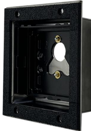
Adattatore per il fissaggio dal retro di 1 modulo Ultra, da incasso, su placche di terze parti. Lo spessore della piastra può variare tra 1.5 e 3mm. L'adattatore è già pronto per essere installato su piastre di 2.5mm di spessore. Dimensioni (L x H x P): 138 x 150 x 37mm.
