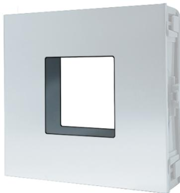
Modulo predisposto per l'alloggiamento delle unità di controllo accessi di terze parti per pulsantiera Ultra, colore bianco RAL9016. Foro 40 x 40 mm. Rivestimento in lega di alluminio anodizzato. Compatibile con i lettori GS3 con montaggio a pannello di Comelit PAC. Dimensioni (L x H x P): 100 x 90 x 35mm. NOTA: la compatibilità meccanica dei lettori con montaggio a pannello di terze parti deve essere controllata e verificata per i diversi modelli!
