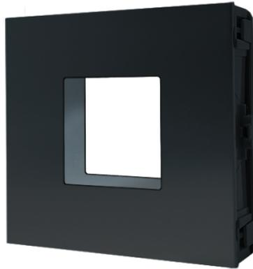
Modulo predisposto per l'alloggiamento delle unità di controllo accessi di terze parti per pulsantiera Ultra, colore nero RAL9005. Foro 40 x 40 mm. Rivestimento in lega di alluminio anodizzato. Compatibile con i lettori GS3 con montaggio a pannello di Comelit PAC. Dimensioni (L x H x P): 100 x 90 x 35mm. NOTA: la compatibilità meccanica dei lettori con montaggio a pannello di terze parti deve essere controllata e verificata per i diversi modelli!
