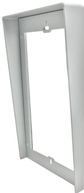
Visiera parapioggia per telai da incasso 6 moduli (2 supporti da 3 moduli affiancati) per pulsantiera Ultra. Realizzata in alluminio anodizzato di colore grigio. Dimensioni (L x H x P): 259 x 322 x 32mm.
