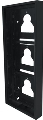
Custodia da parete 3 moduli per pulsantiera Ultra, colore nero RAL9005. E' composto dal supporto metallico che permette di fissare saldamente i moduli senza l'utilizzo di viti e da una cornice realizzata in pressofusione di alluminio trattata per cataforesi per aumentare la resistenza ai processi di corrosione chimica e ambientale, compresi i raggi UV. Sporgenza dalla parete di soli 35 mm. Dimensioni (L x H x P): 110 x 289 x 35mm.
