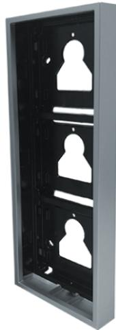
Custodia da parete 3 moduli per pulsantiera Ultra, colore silver RAL9006. E' composta dal supporto metallico che permette di fissare saldamente i moduli senza l'utilizzo di viti e da una cornice realizzata in pressofusione di alluminio trattata per cataforesi per aumentare la resistenza ai processi di corrosione chimica e ambientale, compresi i raggi UV. Sporgenza dalla parete di soli 35 mm. Dimensioni (L x H x P): 110 x 289 x 35mm.
