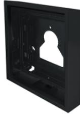
Custodia da parete 1 modulo per pulsantiera Ultra, colore nero RAL9005. E' composto dal supporto metallico che permette di fissare saldamente i moduli senza l'utilizzo di viti e da una cornice realizzata in pressofusione di alluminio trattata per cataforesi per aumentare la resistenza ai processi di corrosione chimica e ambientale, compresi i raggi UV. Sporgenza dalla parete di soli 35 mm. Dimensioni (L x H x P): 110 x 107 x 35mm.
