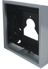
Custodia da parete 1 modulo per pulsantiera Ultra, colore silver RAL9006. E' composto dal supporto metallico che permette di fissare saldamente i moduli senza l'utilizzo di viti e da una cornice realizzata in pressofusione di alluminio trattata per cataforesi per aumentare la resistenza ai processi di corrosione chimica e ambientale, compresi i raggi UV. Sporgenza dalla parete di soli 35 mm. Dimensioni (L x H x P): 110 x 107 x 35mm.
