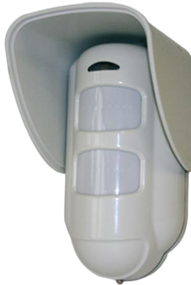
Sensore a tripla tecnologia da esterno con anti-mascheramento. Doppio sensore ad infrarosso e microonda incorporata. Immune, in condizione AND, ad animali con peso corporeo inferiore ai 20 Kg e di altezza inferiore agli 80 cm (con sensore installato ad 1 metro di altezza). Segnalazione ottica della rivelazione di microonda, IR e allarme. Autocompensazione della temperatura. Protezione anti-brandeggio con accelerometro. Grado di protezione IP54. Immunità a luce bianca >10000 lux.
