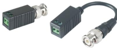
Kit passivo di conversione del segnale video su cavo CAT5/UTP e viceversa, connettori tipo BNC per ingresso/uscita del segnale video, terminali a vite per il collegamento del cavo CAT5/UTP, distanza raggiungibile 300 m (colori) / 600 m (bianco e nero), contenitori plastici, colore nero.
