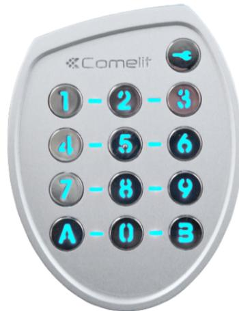
Chiave elettronica antivandalo a codice in zamak, 100 codici da 3 a 6 caratteri, tasti retroilluminati. Relè configurabili in modo monostabile da 1 a 99 secondi o bistabile. Gestione pulsante di uscita, orologio e allarme. Possibilità di relè esterno collegato su seriale RS485. Temperatura da -25°C a +55°C, IP54. Dimensioni 104 x 80 x 19 mm.
