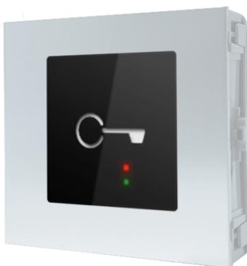
Modulo controllo accessi Simplekey Basic per pulsantiera Ultra, colore bianco RAL9016, compatibile con tutti i sistemi. Dotata di lettore RFID per l'attivazione di un'apertura utilizzando le chiavi o le carte Comelit. 1500 chiavi elettroniche memorizzabili. Rivestimento in lega di alluminio anodizzato. Dimensioni (L x H x P): 100 x 90 x 35mm.
